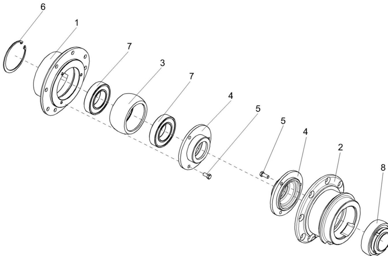
Рисунок 5 – Корпуса КЗК 1873010 и КЗК 1873020
