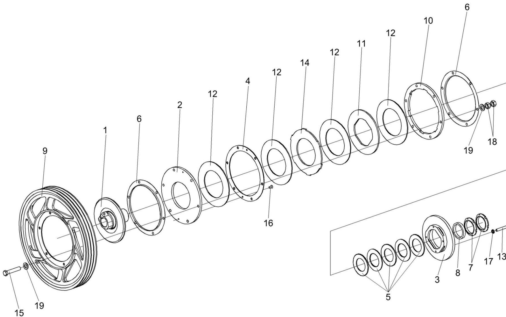
Рисунок 3 – Муфта предохранительная КЗК-10-0502090
